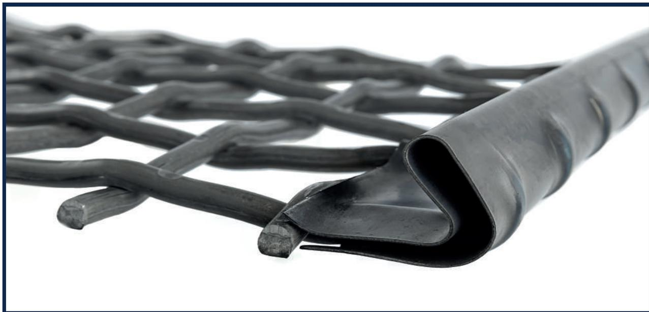
Натяжные фальцы HAVER имеют идеальную геометрию и параллельность относительно друг друга, что позволяет произвести быстрый монтаж сита с равномерной натяжкой. Максимальная длина натяжного фальца 3,2 м.
